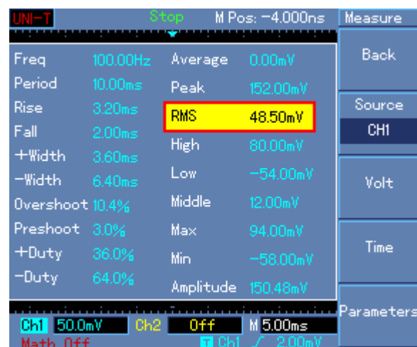
Obr.15 Naměřené hodnoty rozdílového napětí kompenzační transformátor při I_{DC} = 10 A
