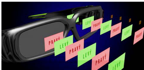
Obr.55 Princip aktivních 3D brýlí
