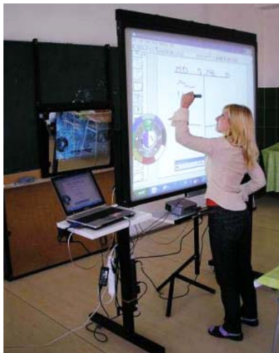
Obr.46 Interaktivní tabule [foto M. Hovančáková] s projektorem s extrémně krátkou projekční vzdáleností a se zadní projekcí
