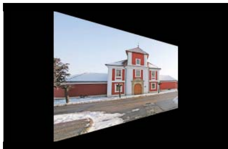
Obr.31 Lichoběžníkové zkreslení obrazu při promítání z pravé strany
