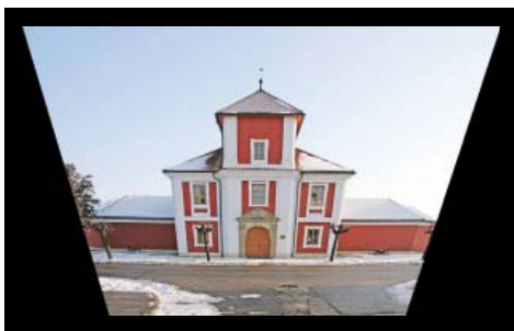
Obr.30 Lichoběžníkové zkreslení obrazu při promítání zespodu
