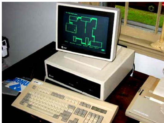
Obr.6 Počítačová sestava AT&T řady 286 monochromatický (zelený) monitor, disketová mechanika 5,25" vpravo dole 9jehličková tiskárna
