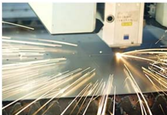
Obr.2 Progresívne spôsoby rezania pomocou elektroiskrového a laserového systému
