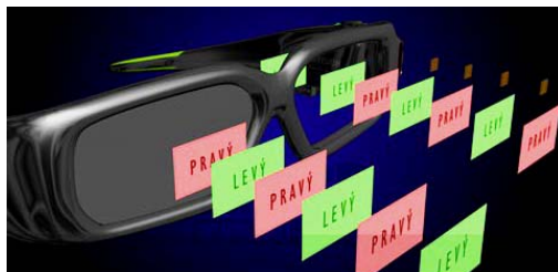
Obr.6 Princip aktivních 3D brýlí Depth-Q [1]
