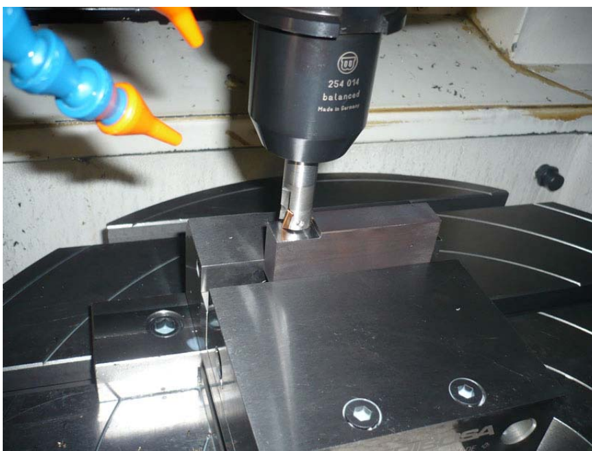
Obr.3 Pohľad na obrábanie ocele pri chladení stlačeným vzduchom
