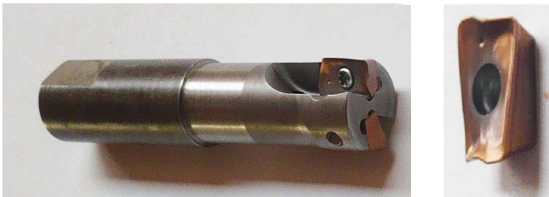
Obr.2 Fréza Sandvik R390-016A16-11L a rezná platnička Sandvik R390-11T308M-KL 3040
