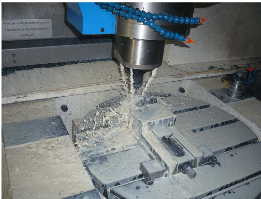
Obr.4 Pohľad na obrábanie ocele pomocou reznej kvapaliny
