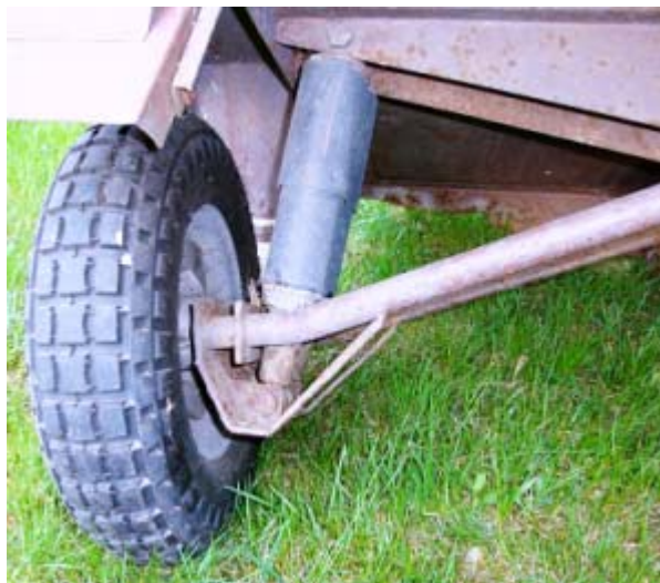
Obr.2 Pohled na uložení kola přívěsu
