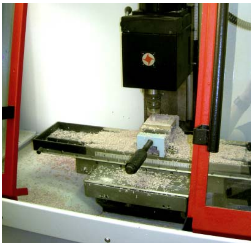
Obr.5 Pohľad na proces frézovania súčiastky stroj FCM 16CNC, riadiaci systém MIKROPROG-F, laboratórium CNC strojov Pdf UHK
