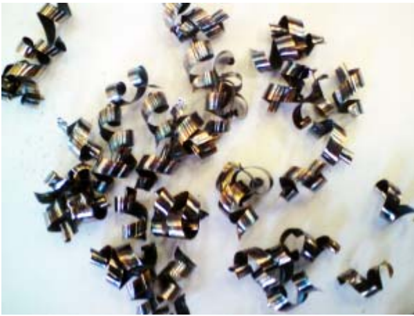
Obr.6 Tvary vznikajúcich triesok pri frézovaní s najmenšou hĺbkou rezu a_{p1} = 1 \text{ mm} (vľavo) a pri frézovaní s najväčšou hĺbkou rezu a_{p3} = 5 \text{ mm} (vpravo)
