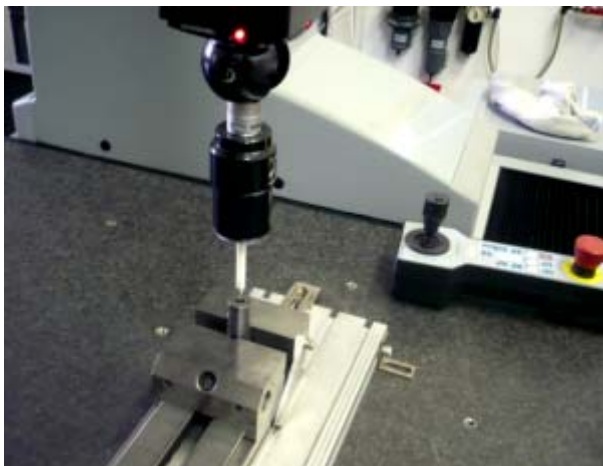
Obr.2 Pohľad na upevnenú súčiastku pri meraní presnosti a kruhovitosti diery
