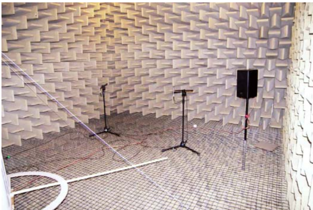
Obr.3 Reprodukční soustava jako zdroj zvuku a konfigurace měřících mikrofónů
