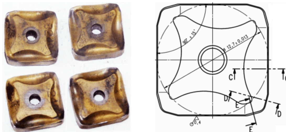
Obr.2 Použité rezné platničky PRAMET zo spekaného karbidu typu 8240 - P30 upnuté v čelnej frézovacej hlavě \varnothing 50 mm NAREX - PN 222460
