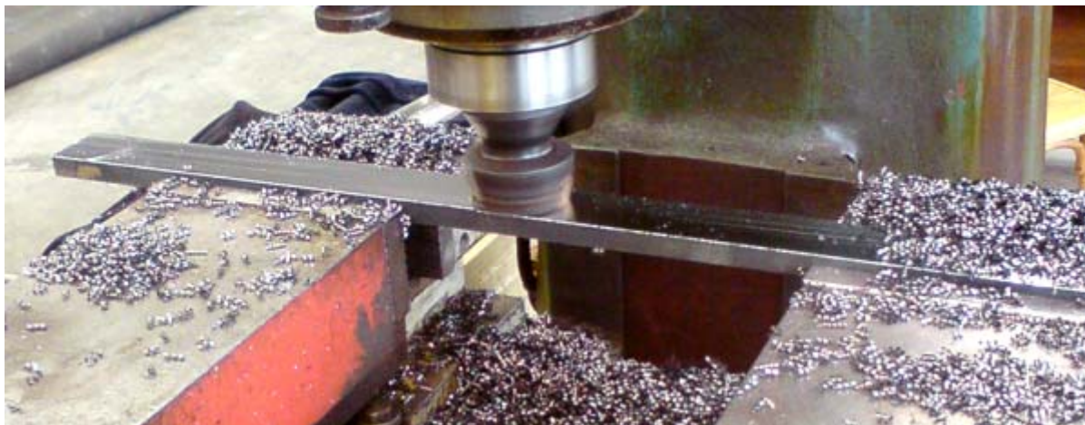
Obr.1 Spôsob upnutia materiálu HARDOX 500 experimentálne skúšky čelného frézovania frézovacou hlavou s VRP-SK (SNHF 1204EN SR-M1, rezný materiál PRAMET 8240) na obrábacom stroji Fa3V
