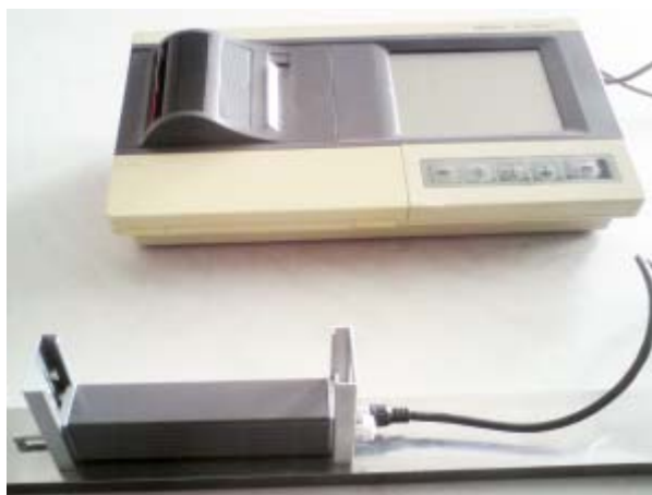
Obr.10 Meranie drsnosti frézovaného povrchu na zariadení SURFTEST SJ-301 po tvrdom čelnom frézovaní oteruvzdorného materiálu HARDOX 500
