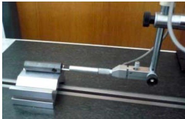
Obr.3 Pohľad na súčiastku pri meraní drsnosti povrchu
