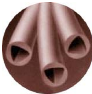
Obr.1 Řez dutým umělým tepelně izolačním vláknem Climashield, XP/APEX
