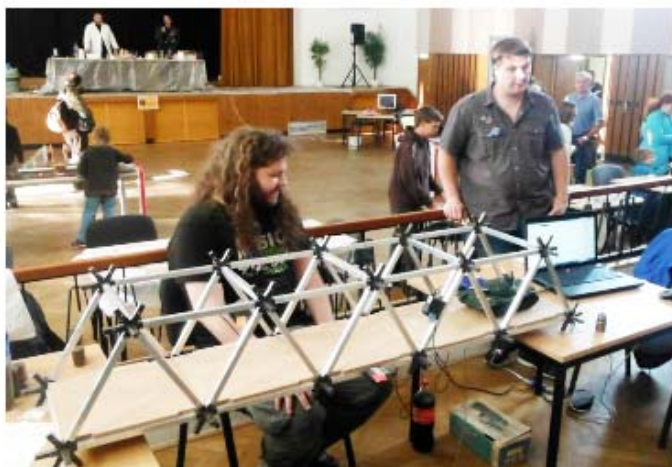
Obr.5 Sada tenzometrů firmy Pasco, měřící rozsah 100 N, rozlišení 0,003 N, sestavený model
