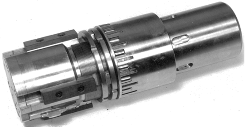
Obr.48 Kombinovaná vystružovacia a valčekovacia hlava s priemerom 110 mm, určená k výrobe hydraulických valcov
