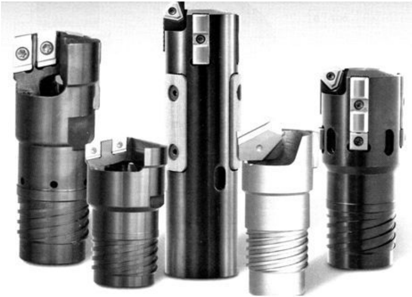
Obr.25 Konštrukcie vŕtacích hláv typu Heller, Widia Krupp, Sandvik Coromant a Iscar podľa [2]
