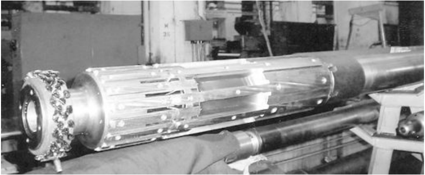
Obr.89 Preťahovacia hlava \varnothing 155 mm so 16 výsuvnými nožmi z rýchloreznej ocele pre ťahanie vnútorných drážok na obrábacom stroji ŠKODA - TZR 16 \times 7000
