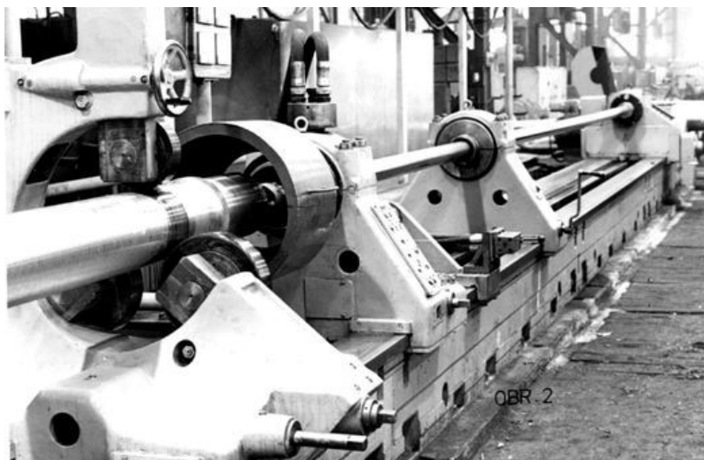
Obr.36 Upravený hĺbokvrtací stroj VHR 500 × 8 000 mm s inštalovaným prístrojom na meranie osovej sily
