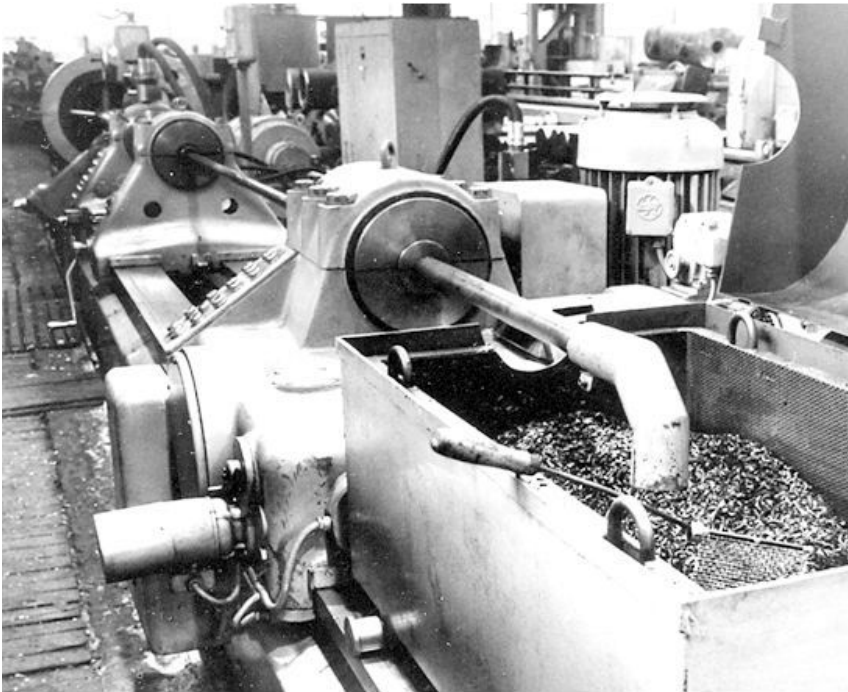
Obr.34 Nádobna na triesky ťahaná pomocou vrtacieho suportu stroja Škoda 500 \times 4\,000 mm s odokrytým vekom pre kontrolu správneho tvaru triesok
