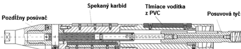
Obr.73 Ťažná vyvrtávací hlava s radiálne staviteľným nožom s VRP-SK kruhového tvaru pre zhotovenie tvarovej komory pri vedení nástroja v predvrtanom otvore podľa [2]
