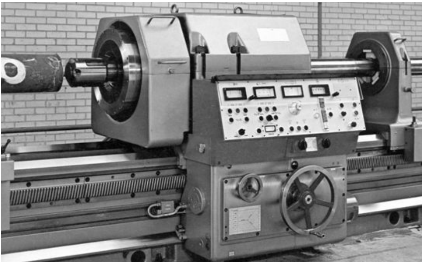
Obr.26 BTA hlbokovŕtací stroj so suportom vpravo podperná luneta s tmičom vibrácií
