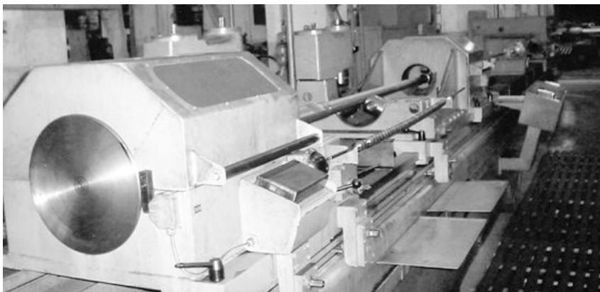
Obr.91 Obrábací stroj SIG-Z 100/3,5 na pret'ahovanie skrutkových drážok
