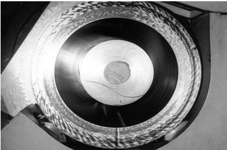
Obr.45 Súčiastka s jadrom vŕtaná na hlbokovŕtacom stroji Schiess s tzv. Froriep rezným nástrojom
