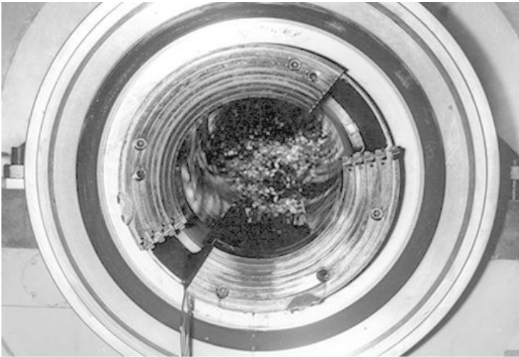
Obr.44 Čelný pohľad na vŕtaciú hlavu na jadro a tlakovú hlavu v upínači
